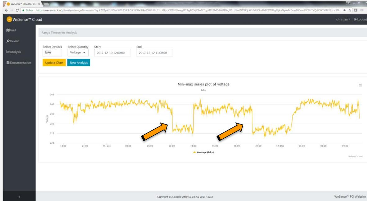
Spannungseinbruch: durch Ladeleistung / Stromfluss
